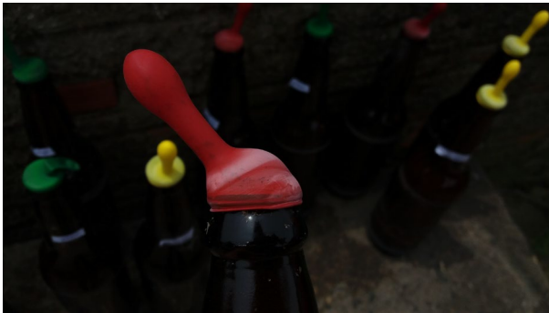
Imagem 6: Ápice de produção de biogás do segundo experimento atribuída aos biodigestores contendo os substratos triturados. Fonte: a autora, 2017.
