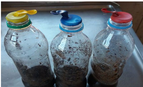
Imagem 1: Primeiros biodigestores confeccionados. Foram utilizadas garrafas de plástico de 600ml e balões de cores distintas acoplados no bocal para identificarem o tratamento recebido pelo substrato.
