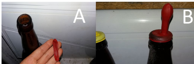
Imagem 7: A - episódio no qual, após agitação, o balão foi expelido. B - registro do balão, após ser acoplado novamente no bocal do biodigestor, enchendo-se. Fonte: a autora, 2017.
