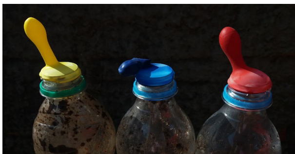
Figura 3: Segundo dia do primeiro experimento, com o ápice de detecção de gases atribuído visualmente ao biodigestor identificado pelo balão vermelho. Fonte: a autora, 2017.
