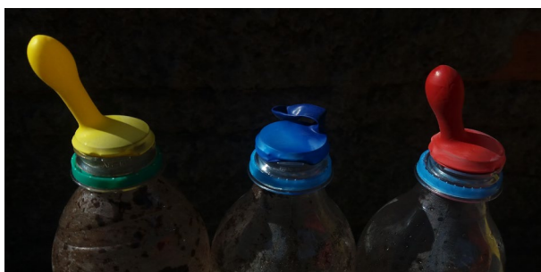
Figura 2: Biodigestores de garrafa PET de 600 ml. O biodigestor identificado pelo balão amarelo contém casca de banana fervida; o identificado pela cor azul, contém cascas in natura ; e por último, o identificado com a cor vermelha contém cascas trituradas com 50ml de água. No primeiro dia do experimento já foi detectada a produção de gases. Fonte: a autora, 2017.
