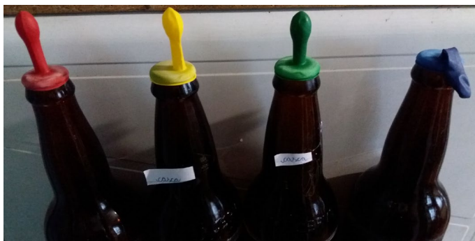
Imagem 5: Segundo protótipo de biodigestor confeccionado utilizando garrafas de vidro escuro de 600ml e balões de cores distintas para identificar o tratamento recebido. O biodigestor identificado pelo balão vermelho contém os resíduos triturados; o que é identificado com a cor amarela contém resíduos fervidos; o biodigestor com o balão verde acoplado contém resíduos in natura ; por fim, o biodigestor com o balão azul contém apenas terra e é utilizado como controle do experimento. Fonte: a autora, 2017.
