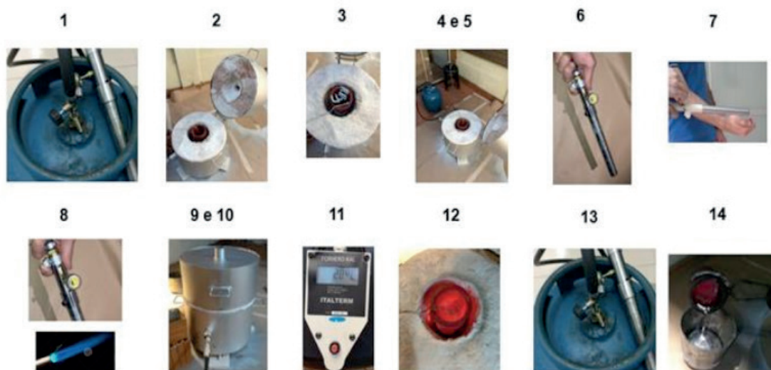
Figura 6. Elementos e etapas para a construção do forno didático.
