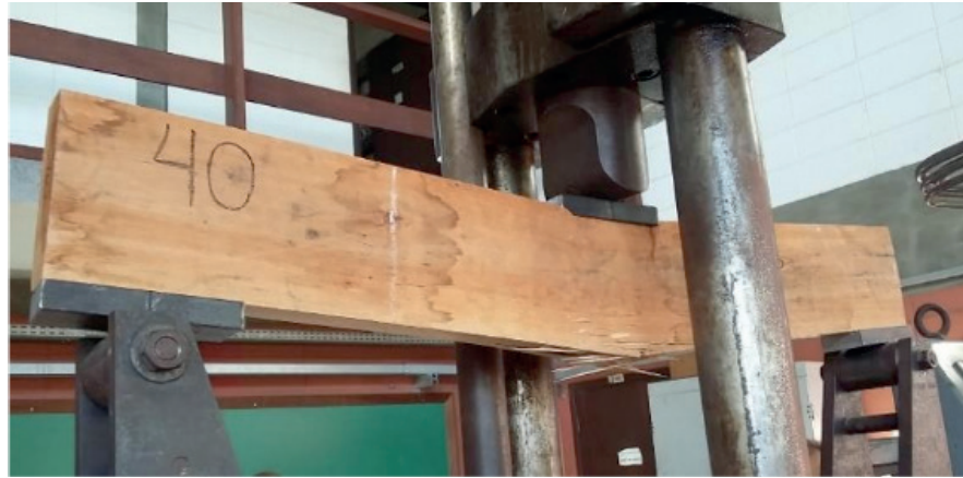
Figura 8 - Ruptura por flexão
