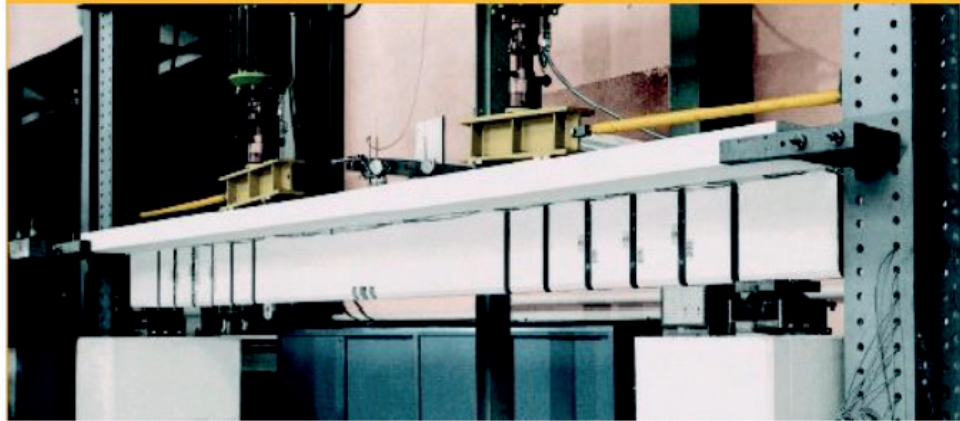
Figura 1: Ensaio de viga reforçada ao cisalhamento no EMPA
