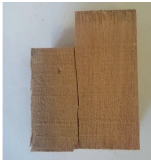
Figura 9 - Ruptura por cisalhamento puro
