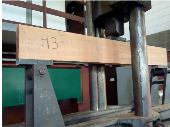
Figura 2 - Ensaio de cisalhamento paralelo às fibras segundo a norma ABNT PN ISO 13910 - 02:126.10-0001-3 (2016)
