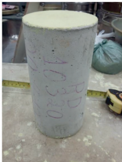
Figura 8: Corpo de prova de concreto
