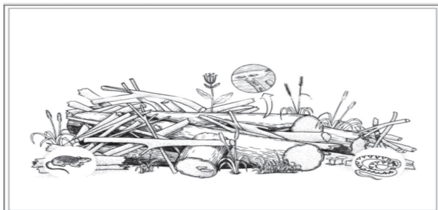
Figura 4 - Ilustração da técnica de transposição de galharia. Fonte: REIS et al. (2003).
