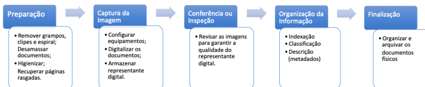
Figura 10 – fases do processo de digitalização
