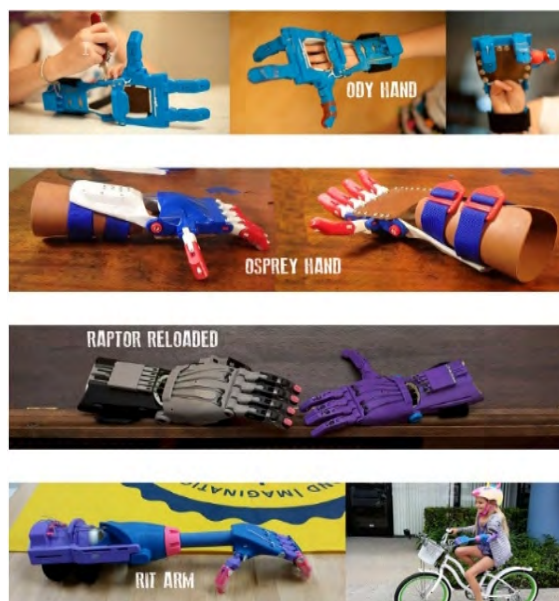
Figura 3 - Próteses 3D para membro superior e mão da e-NABLE.
