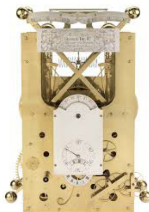
Segundo Cronômetro Marítimo de Harrison. Fonte: Wikimedia Commons
