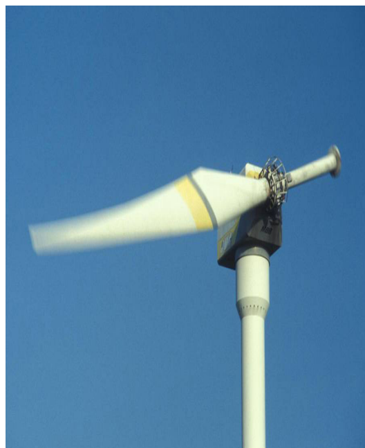
Aerogerador de uma lâmina, Growian. Fonte: https://commons.wikimedia.org
