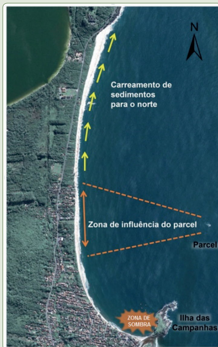
Figura 15.11 – Modelo conceitual proposto para o funcionamento morfodinâmico da Praia da Armação
