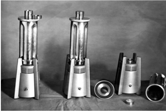
Copos metálicos com capacidade de receber cerca de cinquenta embriões para trituração, realizada por peça metálica provida de palhetas de bordas cortantes, capazes de girar em alta velocidade, quando acionado o motor na base que os sustenta. Rio de Janeiro, RJ, 1946.
