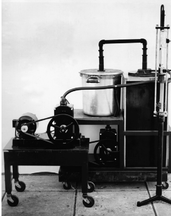
Montagem dos aparelhos — bomba Megavac, dessecador e garrafa térmica que contém o condensador — para o início da operação de dessecação. Rio de Janeiro, RJ, 1941-1943.
