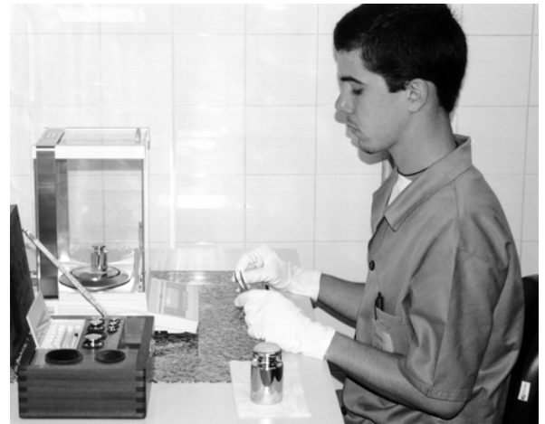
Calibração de balanças de precisão, utilizadas na pesagem das matérias-primas presentes no preparo de soluções e na pesagem de embriões. Fiscalização realizada por funcionário do Programa de Avaliação do Departamento de Qualidade do Laboratório de Metrologia e Validação/LMV de Bio-Manguinhos.
