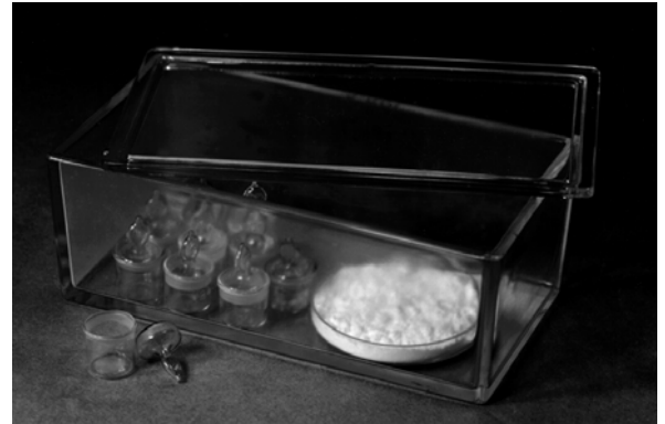
Cuba de vidro com frascos de pesada utilizada para determinação da água residual presente em amostras da vacina dessecada. Rio de Janeiro, RJ, 1941-1943.
