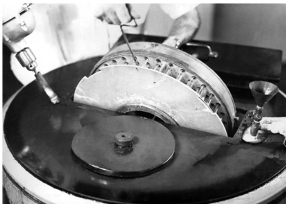
Suporte contendo tubos de vacina para os introduzir em uma câmara metálica que contém álcool mantido em baixa temperatura graças a um refrigerador elétrico especial. O objetivo da operação é dessecar a vacina em estado congelado, para garantir a concentração e eficiência do vírus vacínico. Rio de Janeiro, RJ, 1946.
