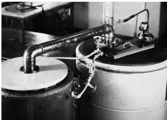
Dessecador da vacina, fechado com tampa de alumínio e ligado por meio de grosso tubo metálico ao condensador que está mergulhado em álcool refrigerado no segundo recipiente. Rio de Janeiro, RJ, 1946.
