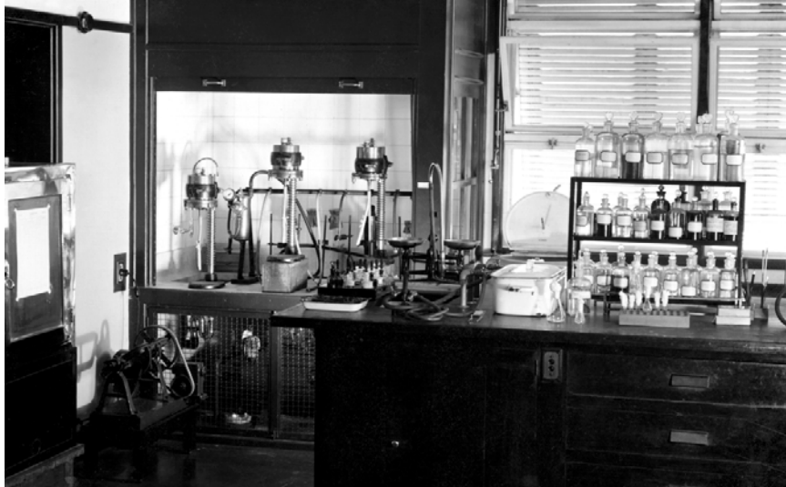
Vista do laboratório principal localizado no Pavilhão Rockefeller, em Manguinhos, num momento de pausa dos trabalhos. Note-se no chão, à esquerda, o moinho de bolas usado para a trituração dos embriões e, acima dele, três filtros Seitz, utilizados na filtragem de soros ou da vacina. Rio de Janeiro, RJ, 1941-1943.
