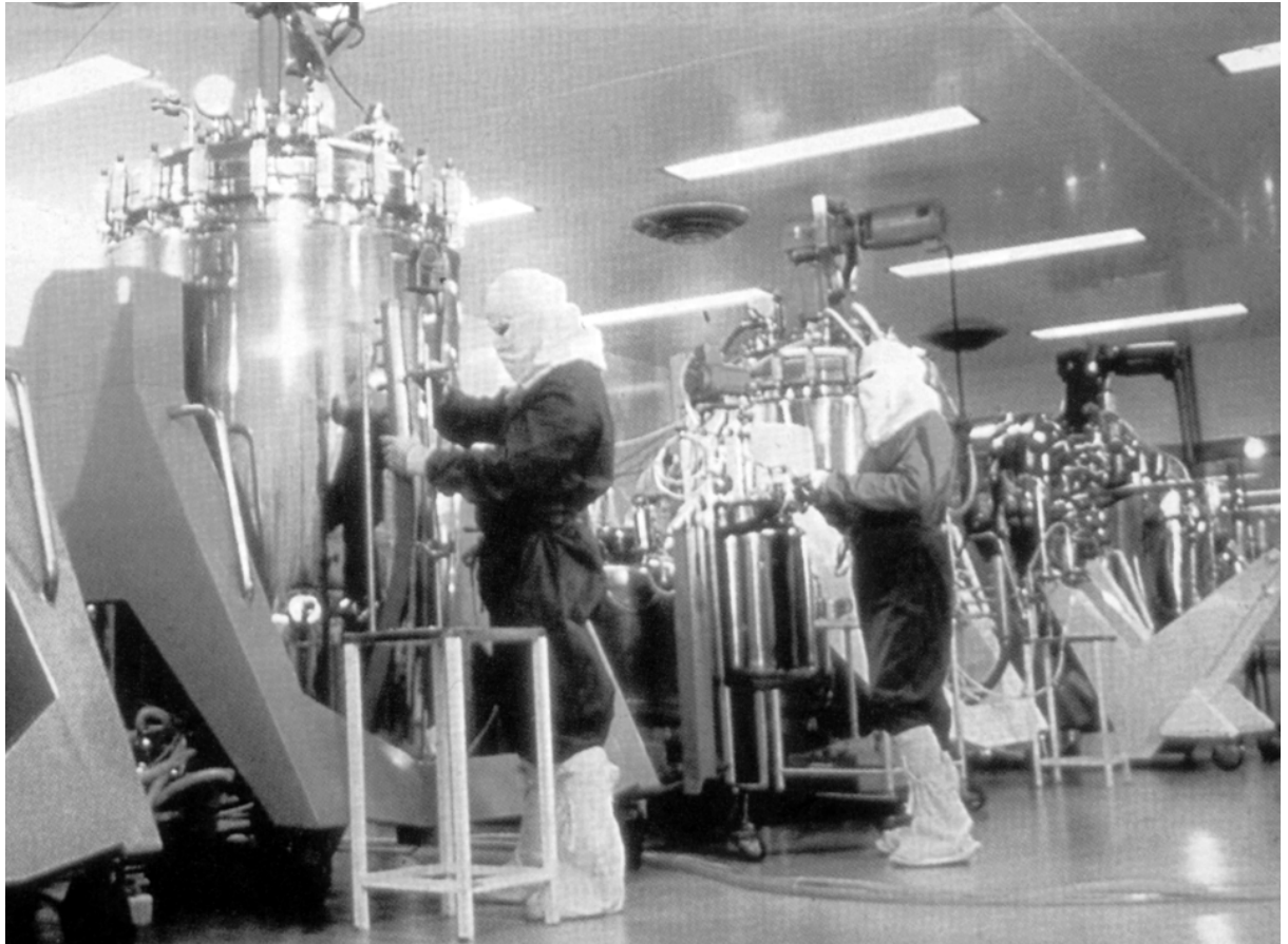
Balões de vidro com cubas de aço na fábrica do Instituto Mérieux, na França. Os fermentadores de mil litros permitiram a produção de grande quantidade de vacina contra a meningite para o Brasil. Estes equipamentos eram bem mais sofisticados do que os transferidos para Bio-Manguinhos.
