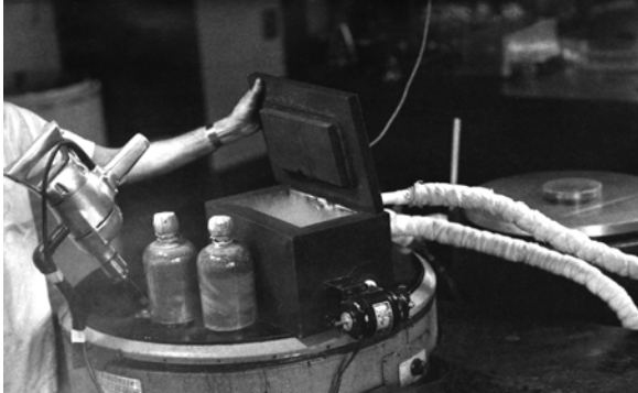
Dispositivo especial que imprime aos vidros contendo polpa embrionária um movimento de rotação lento, enquanto permanecem parcialmente imersos em álcool refrigerado a uma temperatura de cerca de 70°C abaixo de zero. O objetivo da operação é formar, nas paredes laterais dos frascos, uma fina camada de pasta congelada que será armazenada em refrigerador especial. Rio de Janeiro, RJ, 1946. Manual de Instruções Técnicas e Administrativas do Serviço Nacional de Febre Amarela/LAFA/Bio-Manguinhos/Fiocruz
