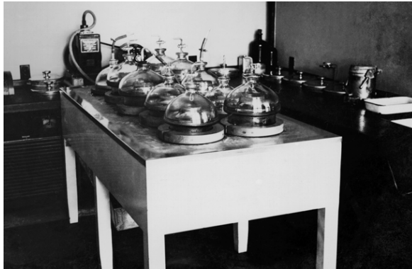
Aparelho de dessecação da vacina, usando vácuo e ácido sulfúrico em mesa refrigeradora. Rio de Janeiro, RJ, 1941-1943. Manual da Vacina/ LAFA/ Bio-Manguinhos/Fiocruz
