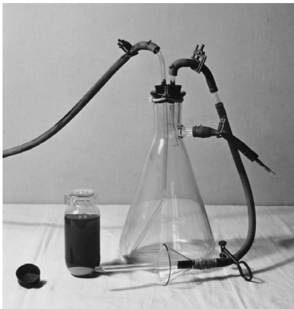
Frasco Kitasato usado para aspirar o sobrenadante (a vacina) de dentro dos tubos de centrifugação. Produzia-se o vácuo no frasco, pouco antes de ser utilizado. A velocidade de aspiração era controlada por uma pinça ajustável, aplicada no tubo de borracha de entrada. A distribuição da vacina era feita diretamente desse frasco para os tubos com 200 doses. Rio de Janeiro, RJ, 1941-1943.
