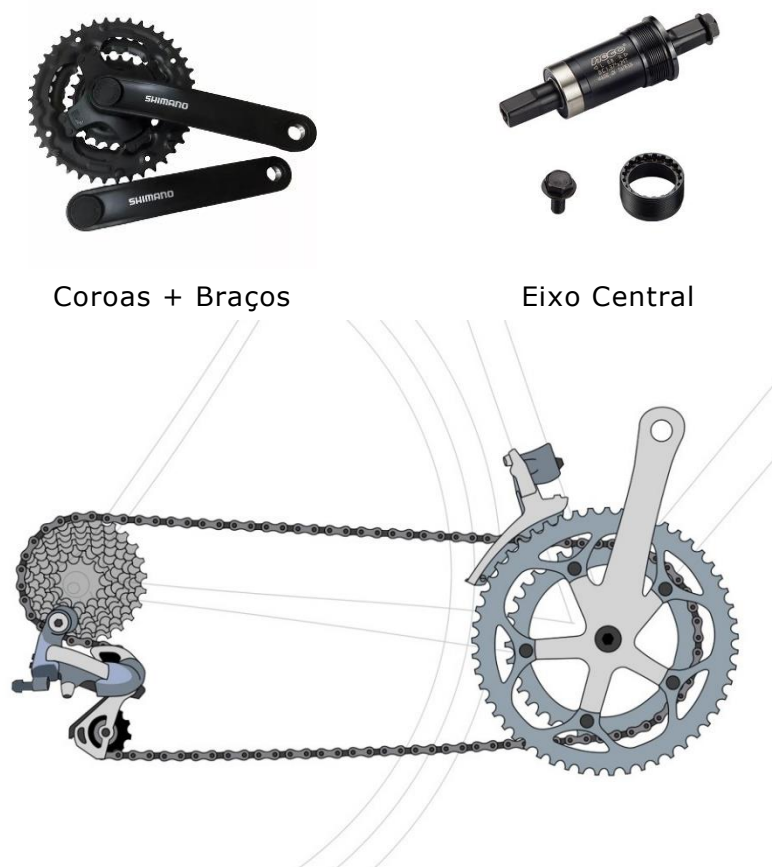
Figura 8 – Coroas + braço, Eixo Central, Conjunto completo do Pedivela + Componentes traseiro e central para o pedalar.
